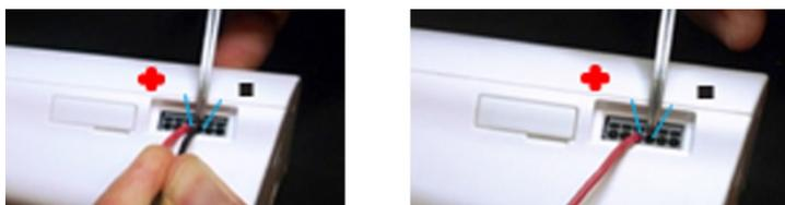
Abbildung 17: Nach unten in die obere rechteckige Öffnung drücken, den Draht einschieben, das Werkzeug entfernen
