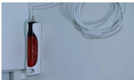
Abbildung 11: An Seitenwand angebrachter Fühler mit Glykol-Ampulle
