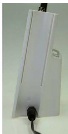
Abbildung 4: Anschluss für externe Stromversorgung
