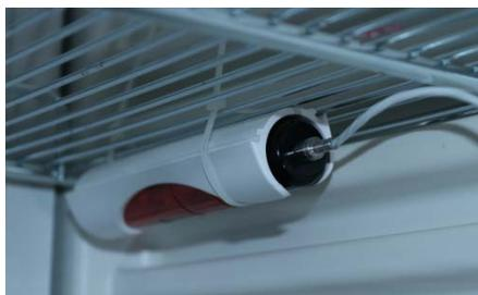
Abbildung 10: Unter dem Regalfach angebrachter Fühler mit Glykol-Ampulle
