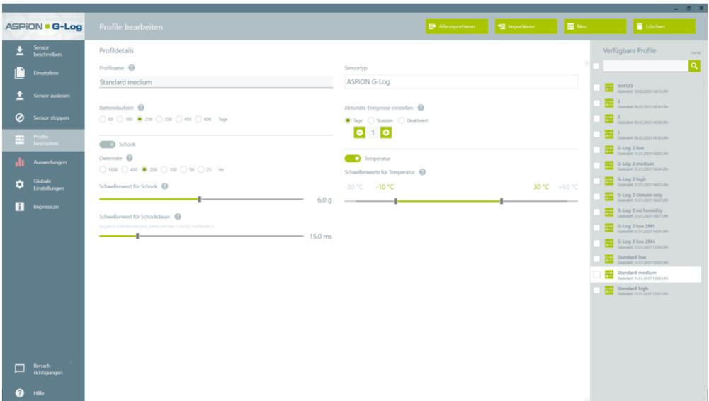
**Speicherkapazität:** Der Datenlogger speichert insgesamt 286 Ereignisse. Im Ringspeicher werden frühere Ereignisse überschrieben, jedoch der erste als auch die höchsten 8 Schockwerte zusätzlich dauerhaft mit Details gespeichert. Das stellt sicher, dass Sie jeweils die höchsten Schock-Belastungen auf Ihr Transportgut detailliert nachvollziehen können.
