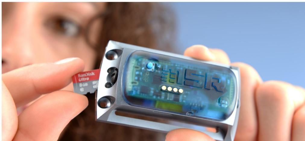
Der mit einem hochauflösenden 3-Achsen-Beschleunigungssensor ( $\pm 15$  g bzw.  $\pm 200$  g) ausgestattete Datenlogger liefert Ihnen wertvolle Messdaten über Schocks, Stöße und Vibrationen. Mit seiner Messrate von 1600/s, der hohen Speicherkapazität und dem geringen Stromverbrauch eignet sich der MSR 165 ideal für Anwendungen in den Bereichen Transportüberwachung, Fehlerdiagnosen und Belastungstests.
