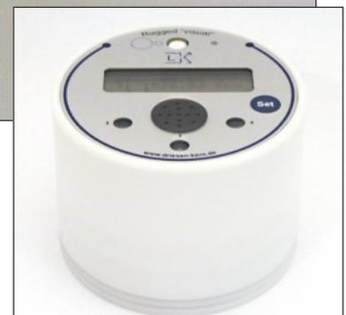
Der CO<sub>2</sub>-Sensor ist nur in dem Modell DK660 integriert
