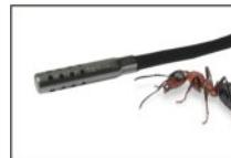
**RFTXXS-325** - Spezialfühler mit extrem kleinen Sensorabmessungen (D=4mm, L=20mm), Sensorkabel: 2m Einsatz: -40...+80/+120°C
