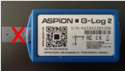
**Wichtig:** Entfernen Sie beim ASPiON G-Log 2 zuerst das Batteriefähnchen, in dem Sie das Fähnchen ganz herausziehen. Erst dadurch ist der Batteriekontakt gegeben und ein Beschreiben möglich. Ein Aufschrauben des Gehäuses ist dafür nicht notwendig.
