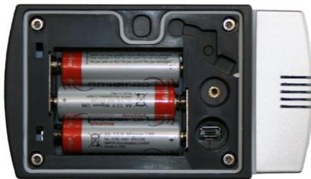
Legen Sie drei neue AA-Alkali-Batterien in das Batteriefach. Achten Sie auf die Polarität.
