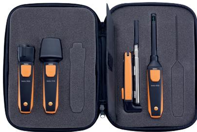
Mit dem Klima-Set messen Sie Luftgeschwindigkeiten, Luftfeuchte, Volumenströme und Temperaturen in, an und rund um Klimaanlage und -systemen. Im robusten testo Smart Case lassen sich die Messgeräte bequem transportieren und sind immer dabei, wenn sie gebraucht werden.
