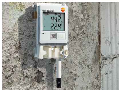
Schimmelprävention – Baufeuchte (testo Saveris 2-H2 mit dem digitalen, externen Feuchtefühler 0572 2154)
