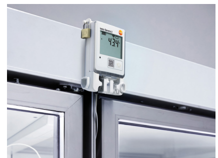
Ultratiefkühlschrank-Überwachung im Labor (testo Saveris 2-T3 mit Temperaturfühler)
