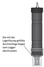
Falls Sie die durchsichtige Lagerkappe entfernt haben, schrauben Sie die Verschlusskappe auf den Logger auf.
