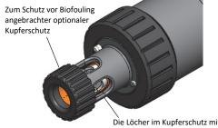
Die Löcher im Kupferschutz mit den Löchern in der Sensor-Endkappe und der pH-Elektrode zur Deckung bringen
