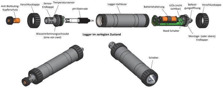
Zusammengebauter Logger mit angebrachtem Kupferschutz
