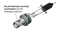
3. Reinigen Sie die inneren O-Ringe mit einem in Wasser getauchten Schaumstoffstäbchen. Verteilen Sie mit diesem Schaumstoffstäbchen eine tropfengroße Menge Silikonfett auf beiden O-Ringen im Innern der Sensor-Endkappe. Verwenden Sie kein Wattestäbchen, da die Fasern auf diesem Stäbchen die Elektrodenfunktion beeinträchtigen können.
