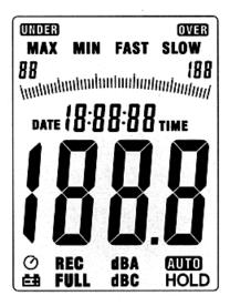
MAX: Maximalanzeige MIN: Minimalanzeige OVER: Überbereichsanzeige UNDER: Unterbereichsanzeige FAST: Schnelle Antwort SLOW: Langsame Antwort dBA: A-Bewertung C-Bewertung dBC: Bereichswahl 88 - 188: Batterieanzeige: Batterie schwach FULL: Speicher voll
