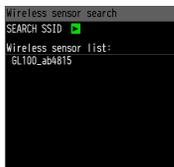
Anschließend wird der Gerätename automatisch registriert, indem aus der angezeigten Liste drahtloser Sensoren der Name des Gerätes ausgewählt wird, zu dem eine Verbindung hergestellt werden soll.
