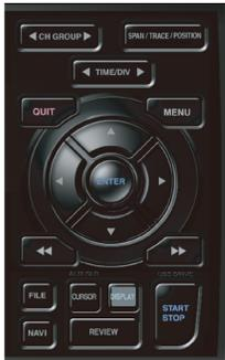
Diese Taste dient zur Umschaltung des Bildschirmmodus. Im Freilaufbetrieb (bei gestoppter Aufzeichnung) kann der Bildschirmmodus zwischen Datenerfassung und Datenwiedergabe während der Erfassung umgeschaltet werden. Durch Drücken dieser Taste wird die Bildschirmanzeige wie folgt umgeschaltet:
