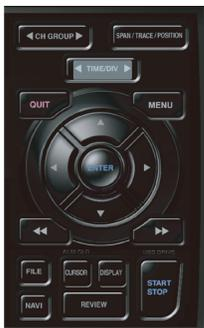
Drücken Sie die linke/rechte [TIME/DIV]-Taste, um die Anzeigebreite in der Zeitachse zu ändern.
