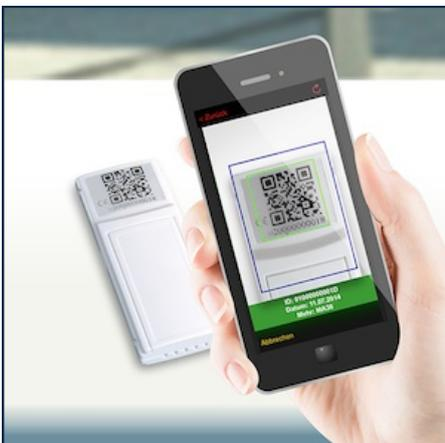
Öffnen Sie die App, es wird die Übersicht angezeigt. Der Sensor Hannover dient nur zu Testzwecken und kann gelöscht werden. Tippen Sie auf „Neuen Sensor hinzufügen“ und scannen Sie den QR Code auf der Rückseite des Temperatursensors. Legen Sie anschließend eine Bezeichnung für den Sender fest. Zur Einstellung eines Namen wählen Sie den Sender durch Antippen aus und berühren dann den Bereich links oben neben dem Stiftsymbol.
