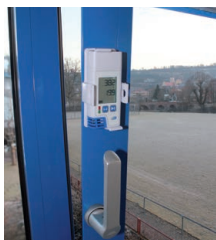
Bewegungsmelder erkennt Öffnen/Kippen des Fensters / Movement detector recognizes opening/tilting of the window
