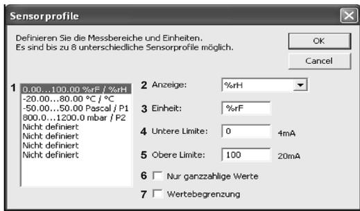
1. Durch Selektieren eines Profils ist es möglich, den Messbereich und die Einheit zu definieren
