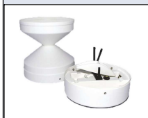
ARG100 Regenmesser preisgünstiger Regenmesser nach dem Kippwaagen-Prinzip Auffangfläche: 506,7 cm 2 Empfindlichkeit: 0,2 mm
