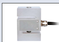
K25 Kraftmessdose Zur Messung v. Druck-/Zugkräften Messbereich: 0,02 bis 50 kN Genauigkeit: 0,1%/0,2%
