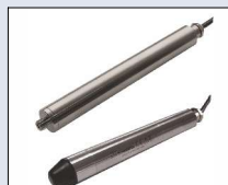
Drucksonden PSense650 Verschiedene Modelle als Pegel- sonde oder als Einschraub- variante im Bereich 1 bar bis 100 bar Auflösung: bis zu 0,1 mm
