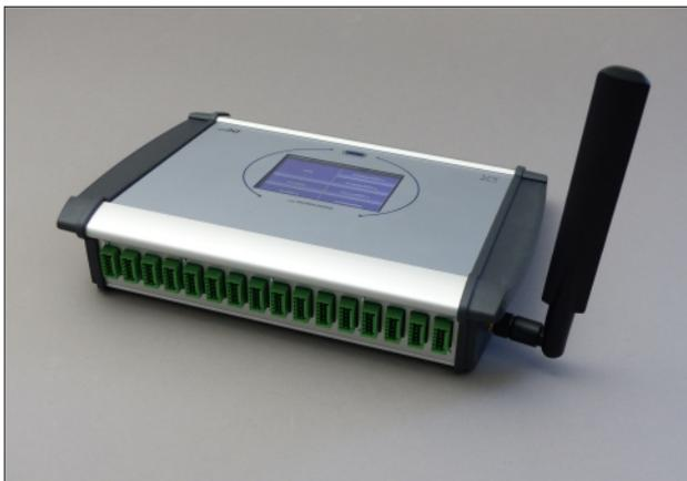
DCXP-16-GPRS mit integriertem Funk-Modem
