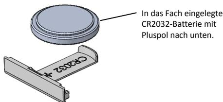
4. Setzen Sie das Fach mit weiterhin nach oben zeigendem LCD-Bildschirm zurück in den Logger ein. Nach ordnungsgemäßem Einlegen der Batterie zeigt der LCD-Bildschirm kurz „HOBO“ an.
