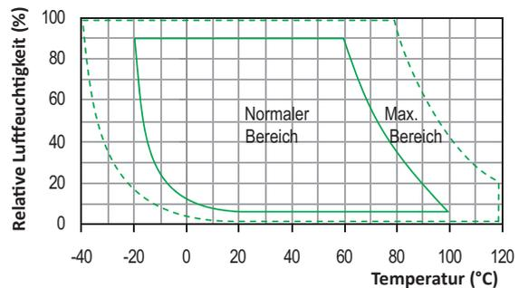
Die RL-Messungen können durch Langzeitbelastung mit Luftfeuchtigkeit außerhalb des „normalen“ Bereichs vorübergehend verschoben werden (±3 % RL nach 60 Stunden). Nach der Rückkehr zu weniger extremen Bedingungen geht das Gerät langsam zum Kalibrierungsstatus zurück.
