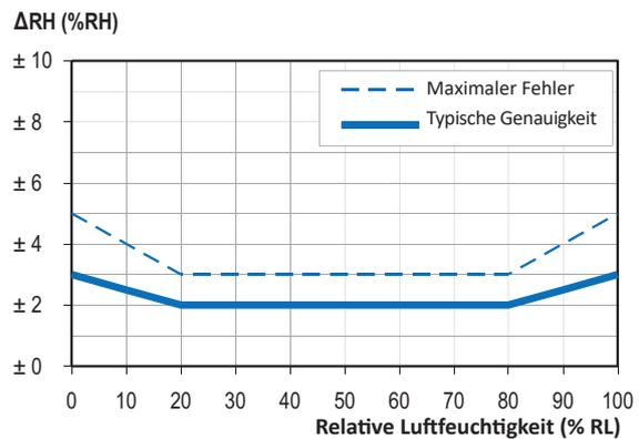
Typische Genauigkeit der Messung der relativen Luftfeuchtigkeit in % RL für Temperaturen von 0 bis 80 °C.
