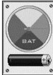
Abbildung 5: Batterieanzeige des Rissfox Mini
