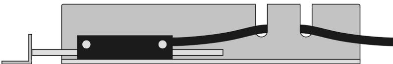
Nachdem die Riss – Analyse – Sensorik über dem Riss montiert wurde, muss der Sensor an der Buchse „Riss Analyse Sensor“ des Datenloggers angeschlossen werden.
