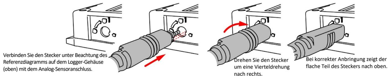
2. Stellen Sie in HOBOnnect eine Verbindung mit dem Logger her und tippen Sie auf . Der Sensortyp wird automatisch ausgewählt. Konfigurieren Sie alle anderen gewünschten Sensoreinstellungen und tippen Sie auf . Einzelheiten zum Konfigurieren des Loggers finden Sie im HOBOnnect-Benutzerhandbuch unter <https://www.onsetcomp.com/hoboconnect>.
