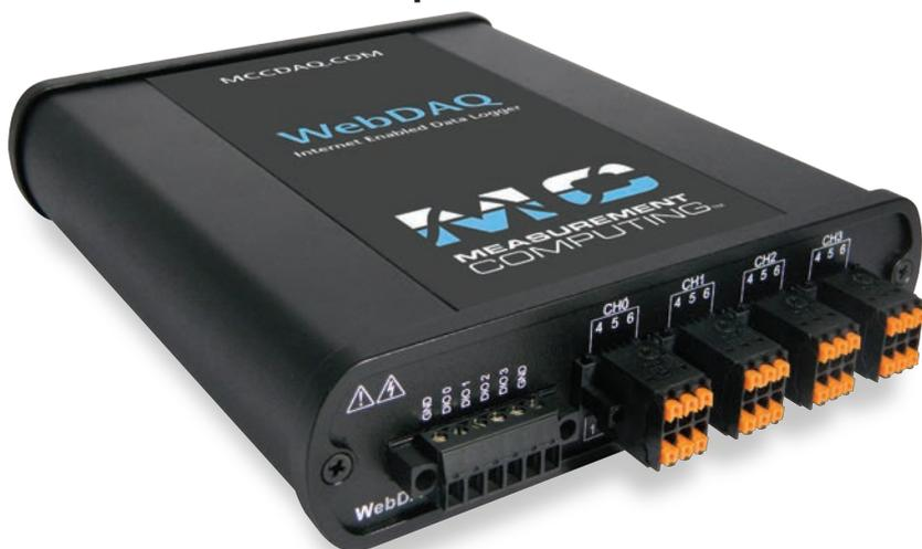
Der **WebDAQ 904** Datenlogger mit universellen Eingängen bietet 4 Kanäle zur Messung von Spannung (bis  $\pm 60$  V), Strom, Thermoelementen, Widerstandsthermometern, Widerstand und DMS.
