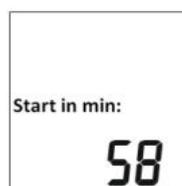
(Die Rückzählung auf Null erfolgt in Messintervall-Schritten, z.B. Messintervall = 10 min. >> Rückzählung 60 - 50 - 40 - ...)
