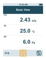
Je nach angeschlossenem Fühler können Parameter für die Messung eingestellt werden, wie beispielsweise die Sichtbarkeit einzelner Werte oder die Finheiten.
