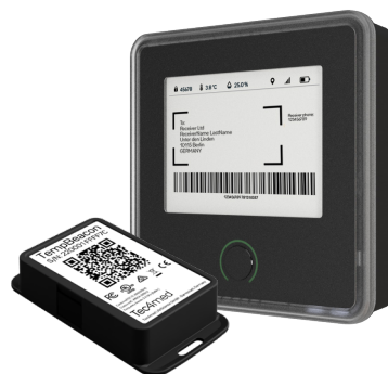
SmartHub dient als Gateway für mehrere Beacons und Datenlogger.
