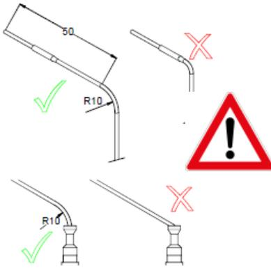
Beim Biegen nahe dem Gehäuse ist die mechanische Beanspruchung durch die Gehäusekante zu groß. In den 50 mm an der Spitze des Fühlers befindet sich der Sensor.
