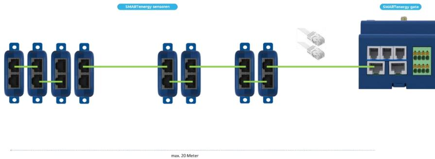
Der Anschluss der SMARTenergy Sensoren erfolgt über Standard RJ45 Netzkabel AWG27. Es können bis zu 8 SMARTenergy Sensoren an der SEB Anschlussdose angeschlossen werden. Die max. Distanz zwischen Anschluss SMARTenergy gate und letzter SMARTenergy sensor ist 20m.
