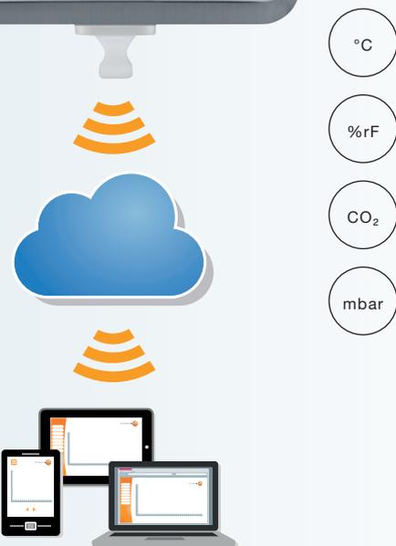
Das Funk-Datenlogger-System testo Saveris 2 ist die moderne Lösung zur Überwachung von Temperatur- und Feuchtwerten sowie der CO<sub>2</sub>-Konzentration in Lager- und Arbeitsräumen. Die Installation des Systems ist kinderleicht und kann über den Browser vorgenommen werden. Die Funk-Datenlogger zeichnen Temperatur, Feuchte und CO<sub>2</sub>-Konzentration in einstellbaren Intervallen zuverlässig auf und übertragen die Messwerte über WLAN in die Testo-Cloud.
