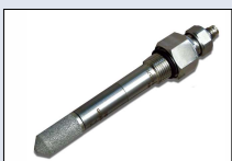
DKRF374 - Feuchte-/Temperaturfühler für Druckluft bis 100bar, G3/8" Gewinde, Abmessungen D=13 mm x 100 mm Einsatz bei -20...+80°C.
