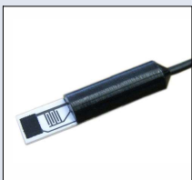
SHS - Spezialfühler zur Messung einsetzender Betauung. Kondensationsensor liefert Signal 1, wenn Benetzung mit Wasser in Folge von Kondensation auftritt. Abmessungen: 60 x 10 mm Einsatz 0...50°C
