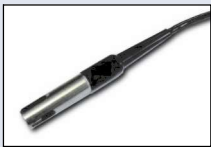
RFT - Fühler zur Messung von Luftfeuchte und Temperatur. Einsatz bei -20... +80°C bzw. -40/+120°C mit Spezialkabel Typ G. Abmessungen: D=8x35 mm
