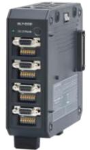
Das Eingangsmodul für DMA und DMS-Sensoren GL7-DCB ist ein optionales Modul für das Messdatenerfassungssystem GL7000. Durch den eingebauten Verstärker können DMS und DMS-Sensoren direkt an das Modul angeschlossen werden. Außerdem werden sie vom Modul mit Speisestrom bzw. Speisespannung versorgt
