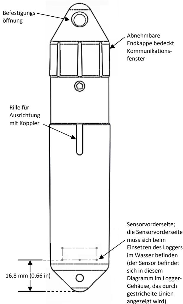
Der Logger kann zwei Arten von Daten aufzeichnen: Proben und Ereignisse. Proben sind die Sensormessungen, die bei jedem Speicherintervall aufgezeichnet werden (z. B. der Druck jede Minute). Ereignisse sind unabhängige Vorkommnisse, die durch eine Logger-Aktivität ausgelöst werden, z. B. wenn die Batterie defekt ist oder ein Host angeschlossen wird. Mithilfe von Ereignissen können Sie bestimmen, was geschehen ist, während der Logger protokolliert hat.
