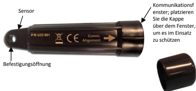
**Wichtiger Hinweis:** Das Kunststoffgehäuse wird bei Temperaturen unter  $-20\text{ }^{\circ}\text{C}$  brüchig. Wird der Logger an einer Stelle eingesetzt, an der die Temperatur unter  $-20\text{ }^{\circ}\text{C}$  fällt, müssen Sie dafür sorgen, dass der Logger stationär bleibt und dass er nicht gezogen oder angestoßen wird. Bringen Sie den Logger vor dem Handhaben auf eine Temperatur über  $-20\text{ }^{\circ}\text{C}$ .
