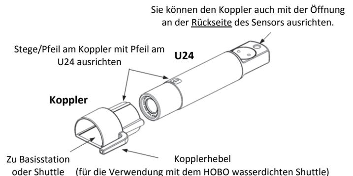
**WARNUNG:** Lassen Sie den Logger nicht für längere Zeit im Koppler. Wenn der Logger mit dem Koppler verbunden ist, befindet er sich im „wachen“ Zustand und verbraucht viel mehr Strom, als wenn er abgetrennt ist und sich im „Ruhemodus“ befindet. Trennen Sie den Logger sobald wie möglich nach dem Starten, Auslesen oder Prüfen des Status von der optischen Basisstation oder dem HOBO wasserdichten Shuttle, um die Batterie nicht zu entleeren.
