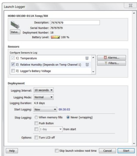
3. **Alarmer einrichten (optional).** Drücken Sie die Alarmtaste, wenn Sie einen Alarm einstellen möchten, der angeht, wenn sich die Sensormesswerte oberhalb oder unterhalb eines von Ihnen eingestellten Wertes bewegt. Weitere Informationen hierzu finden Sie unter *Alarmer einrichten*.
