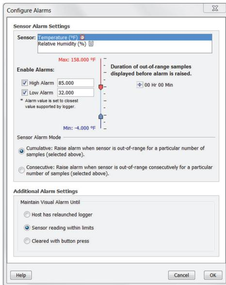
3. Aktivieren Sie die Checkbox „Alarm Max“, wenn Sie möchten, dass ein Alarm ausgelöst wird, wenn der Sensormesswert den Wert „Alarm Max“ übersteigt. Geben Sie den Wert neben der Checkbox „Alarm Max“ ein oder verschieben Sie den oberen roten Regler im Fenster „Alarmer konfigurieren“.
