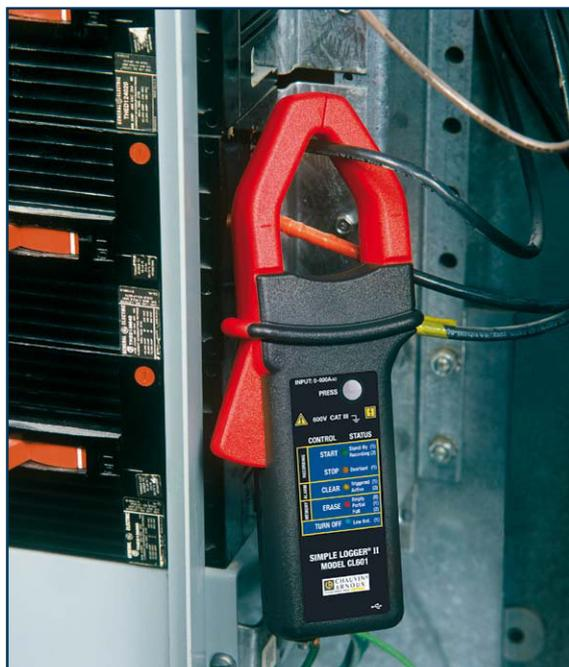
Einfache Erfassung des Stroms an einer Schalttafel
