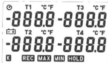
**T1 ... T4:** Ordnet den Kanal der entsprechenden angezeigten Temperatur zu
