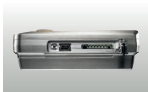
Seitlicher Anschluss von Mini-USB-Kabel und SD-Karte
