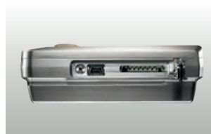
Seitlicher Anschluss von Mini-USB-Kabel und SD-Karte
