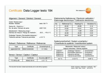
Die Temperatur-Datenlogger testo 184 T1, T2, T3 und T4 werden mit einem Abnahmeprüfzeugnis gemäß DIN ISO 10204 ausgeliefert. Weitere rückverfolgbare Kalibrierzertifikate nach ISO 17025 oder DAkkS sind auf Anfrage verfügbar.
