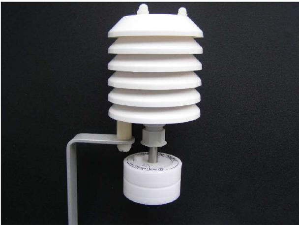
Das Foto zeigt die Strahlungsschutzhaube TR351 mit unserem Datenlogger HumiBaroLog aus der ruggedPlus Serie. Mehr Informationen zu diesem Logger für Temperatur, Luftfeuchte und barometrischen Druck und anderen Modellen finden Sie im separaten Datenblatt.
